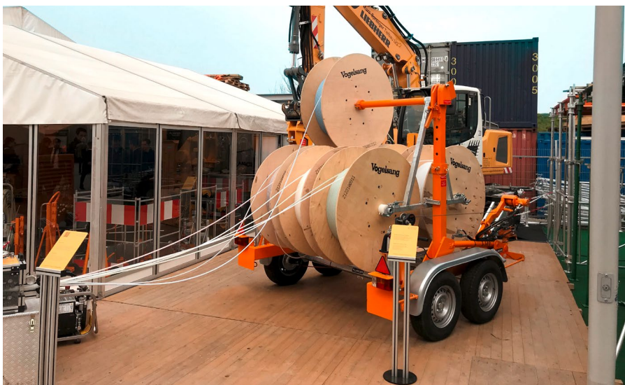
Verlegewagen der Firma Lancier, bestückt mit FiberSpeed® 10 × 1,0 mm Monorohren
