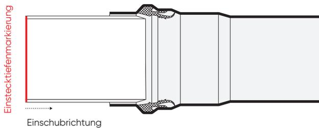
**1** Gerader Einschub des Rohrspitzendes in die Steckmuffe. Das Rohr bei Bedarf mit geeignetem Werkzeug rechtwinklig abschneiden, anfasen (15°), entgraten und das einzusteckende Rohrende dünn mit Gleitmittel nach Herstellervorgabe versehen. Die Lage und Unversehrtheit des Dichtrings prüfen. Muffen und Einsteckende reinigen.
