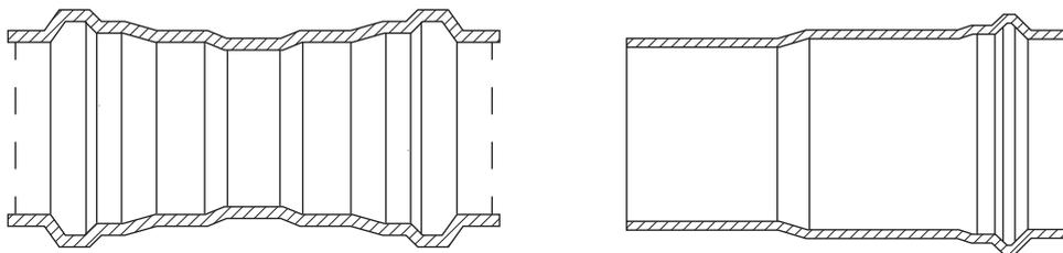
Beispiel für elastomergedichtete Verbindungen
