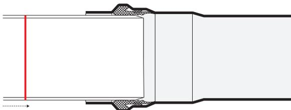
**2** Durch das Überfahren der Kompressionslippe des Vogelsang-Spezial-2-Phasen Dichtrings mit dem Rohrspitzende wird überschüssiges Gleitmittel entfernt und der Profildichtring in der Muffe gegen Herausdrücken gesichert.
