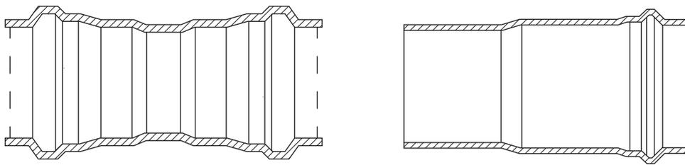
Beispiel für elastomergedichtete Verbindungen
