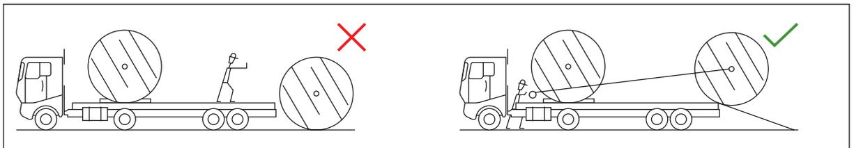
**Lastkraftwagen:** Gesichertes Abrollen vom Fahrzeug
