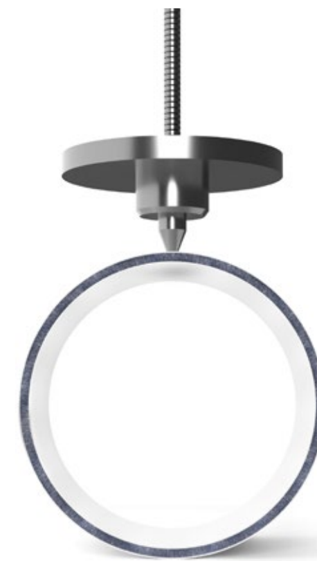
Pickelschlagprüfung nach DIN 16876
